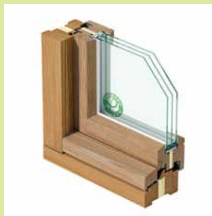
Het passiefkozijn is opgebouwd uit gevingerlast gelamineerd Vilam sandwich lariks met in de kern van het profiel twee verlijmd isolatielagen puschuim en purenit.
